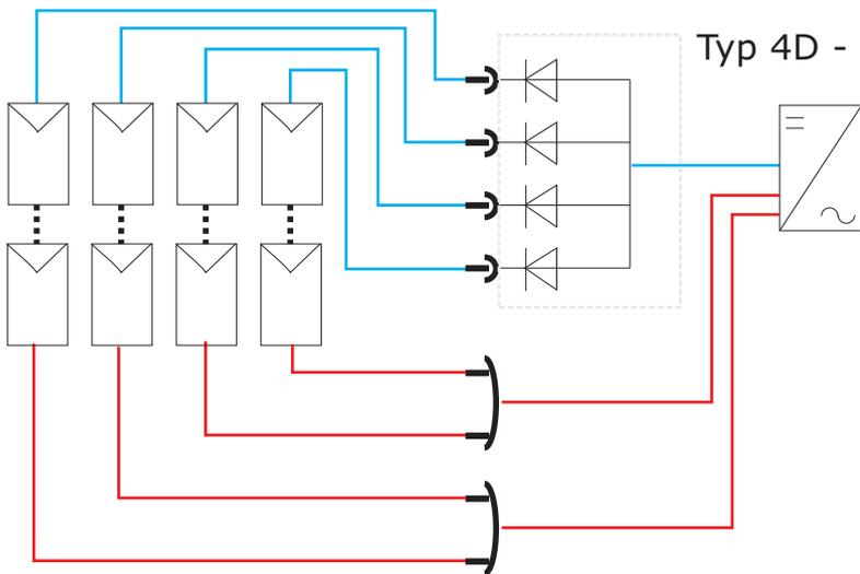
Alternativ könnten an dieser Stelle auch Y-Stecker verwendet werden, wenn z.B. Am Wechselrichter 2 parallele Eingänge vorhanden sind.
