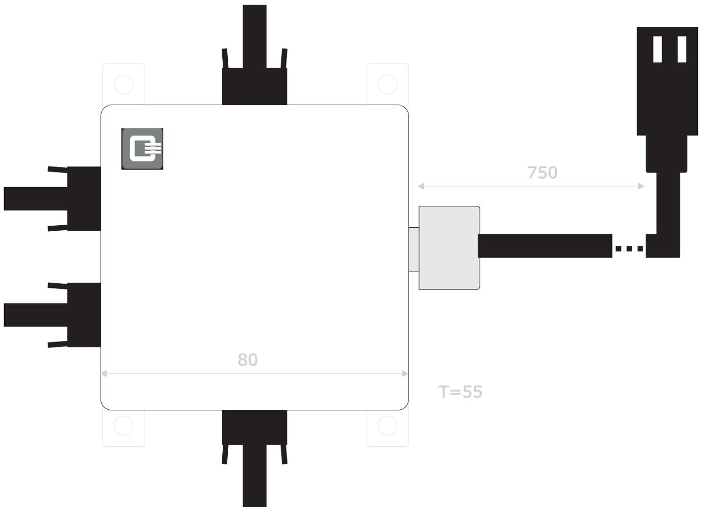
Multiflexible Anschlussbox für PV Strings
